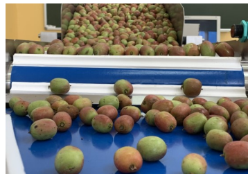
Fot. 21. Sortowanie owoców ma na celu odrzucenie owoców niehandlowych i nadmiernie dojrzałych.
